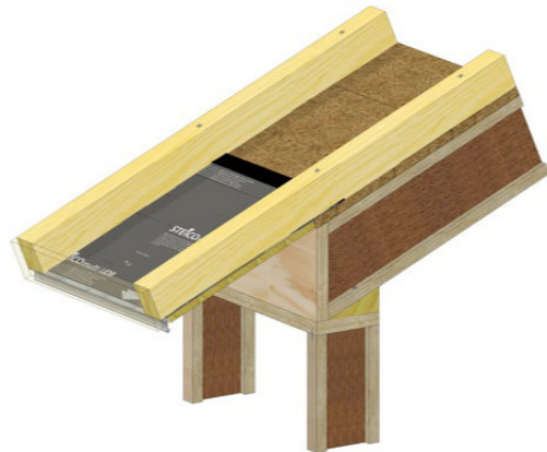
Rys. 155. Okap wystający poza obrys dachu z podbitką.
