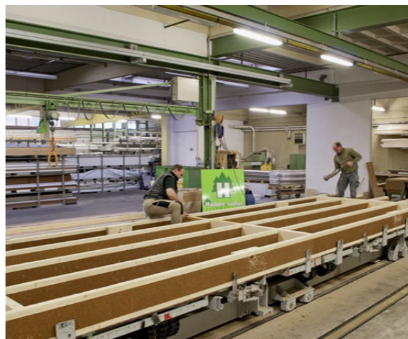
Montaż konstrukcji elementu dachowego z wykorzystaniem belek dwuteowych STEICOjoist.
