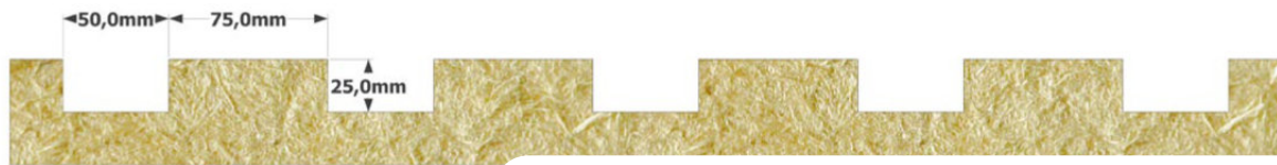
Rys. 215. Fabryczne nacięcia w strukturze płyt STEICOinstall.
