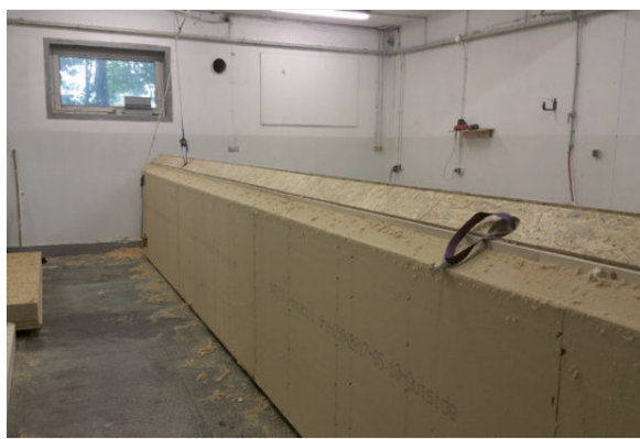
Prefabrykacja ścian STEICO w zakładzie FuturaDom Sp. z o.o.: słupki ścienne z belek KVH/STEICOwall 60×160 mm, oczipce i podwalina ze STEICO LVL R 39/45×160 mm; termoizolacja STEICOzell 160 mm oraz STEICOprotect L dry 100 mm.
