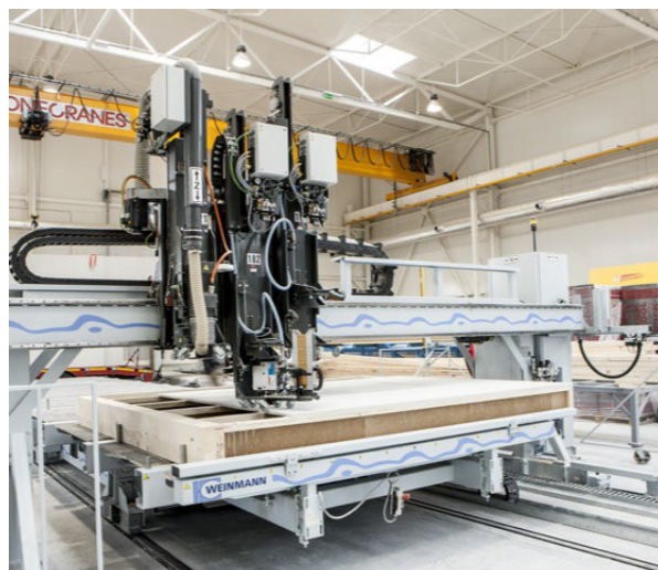
Proces prefabrykacji systemowej ściany STEICO przy użyciu nowoczesnego parku maszynowego.
