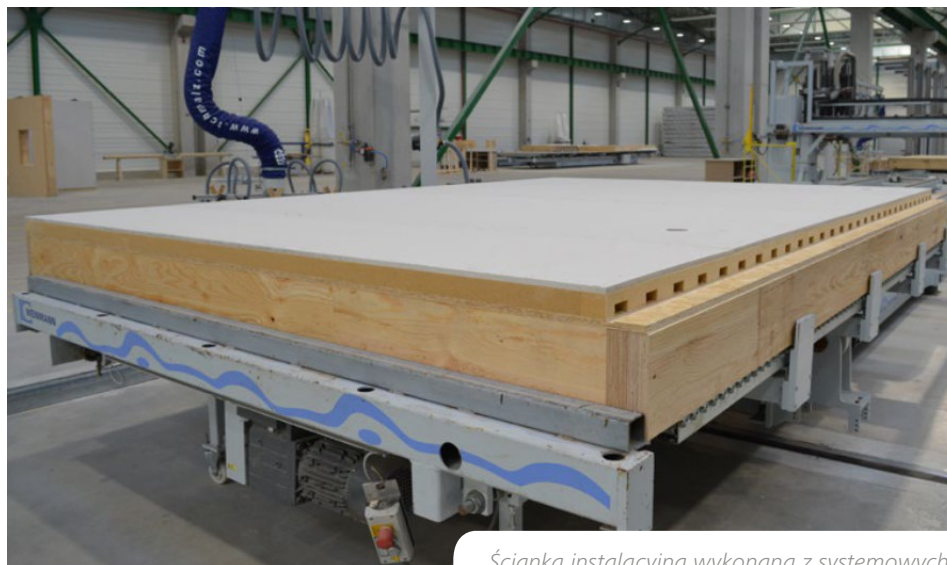
Ścianka instalacyjna wykonana z systemowych płyt STEICOinstall.
