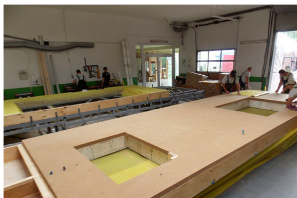
Prefabrykacja ścian STEICO w zakładzie SZREDER A.C.: słupki ścienne z belek dwuteowych STEICOWall 60x240 mm, oczep i podwalina ze STEICO LVL R 45x240 mm; izolacja cieplna STEICOflex 038 240 mm oraz STEICOprotect H 60 mm.
