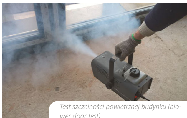
Test szczelności powietrznej budynku (blower door test).
