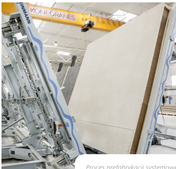
Proces prefabrykacji systemowej ściany STEICO przy użyciu nowoczesnego parku maszynowego.
