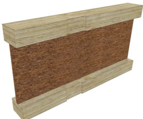
Rys. 57. Nacięcia boczne w pasach z forniru klejonego warstwowo.
