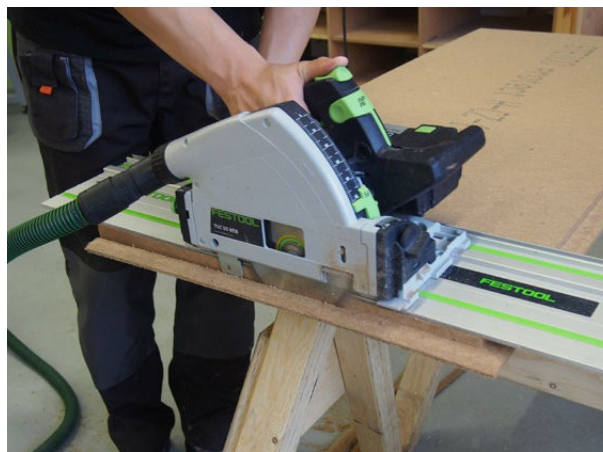
Obróbka płyt nakrokwiowych STEICO – usunięcie pióra w przypadku płyt skrajnych.
