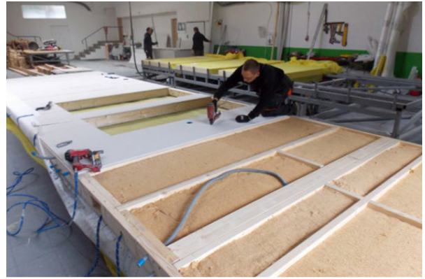
Prefabrykacja ścian STEICO w zakładzie SZREDER A.C.: słupki ścienne z belek dwuteowych STEICOWall 60x240 mm, ociep i podwalina ze STEICO LVL R 45x240 mm; izolacja cieplna STEICOflex 038 240 mm oraz STEICOprotect H 60 mm.
