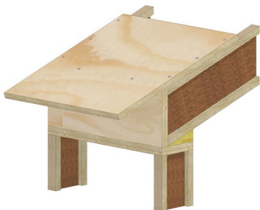
Rys. 156. Deska okapowa z płyty STEICO LVL X.
