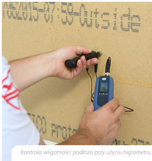
Rys. 108. Graniczna zawartość wilgoci w płytach fasadowych STEICO umożliwiająca rozpoczęcie prac tynkarskich.
