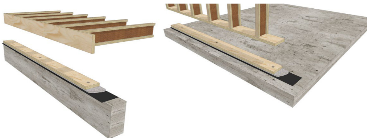
Rys. 69. Podwalina montażowa ze STEICO LVL zakotwiona do płyty fundamentowej.
