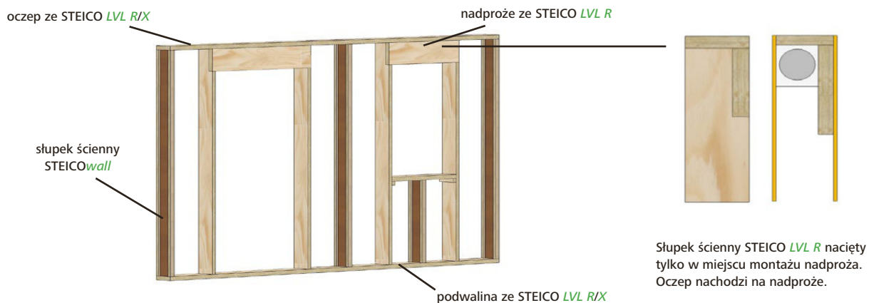
Rys. 64. Nadproże ze STEICO LVL R wbudowane na sztorc jako belka jednoprzęsłowa.
