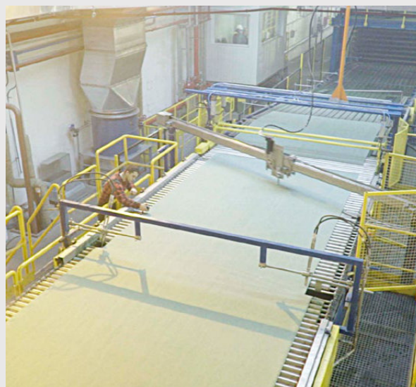
Linia technologiczna do produkcji płyt pilśniowych porowatych – zakład STEICO Czarnków.
