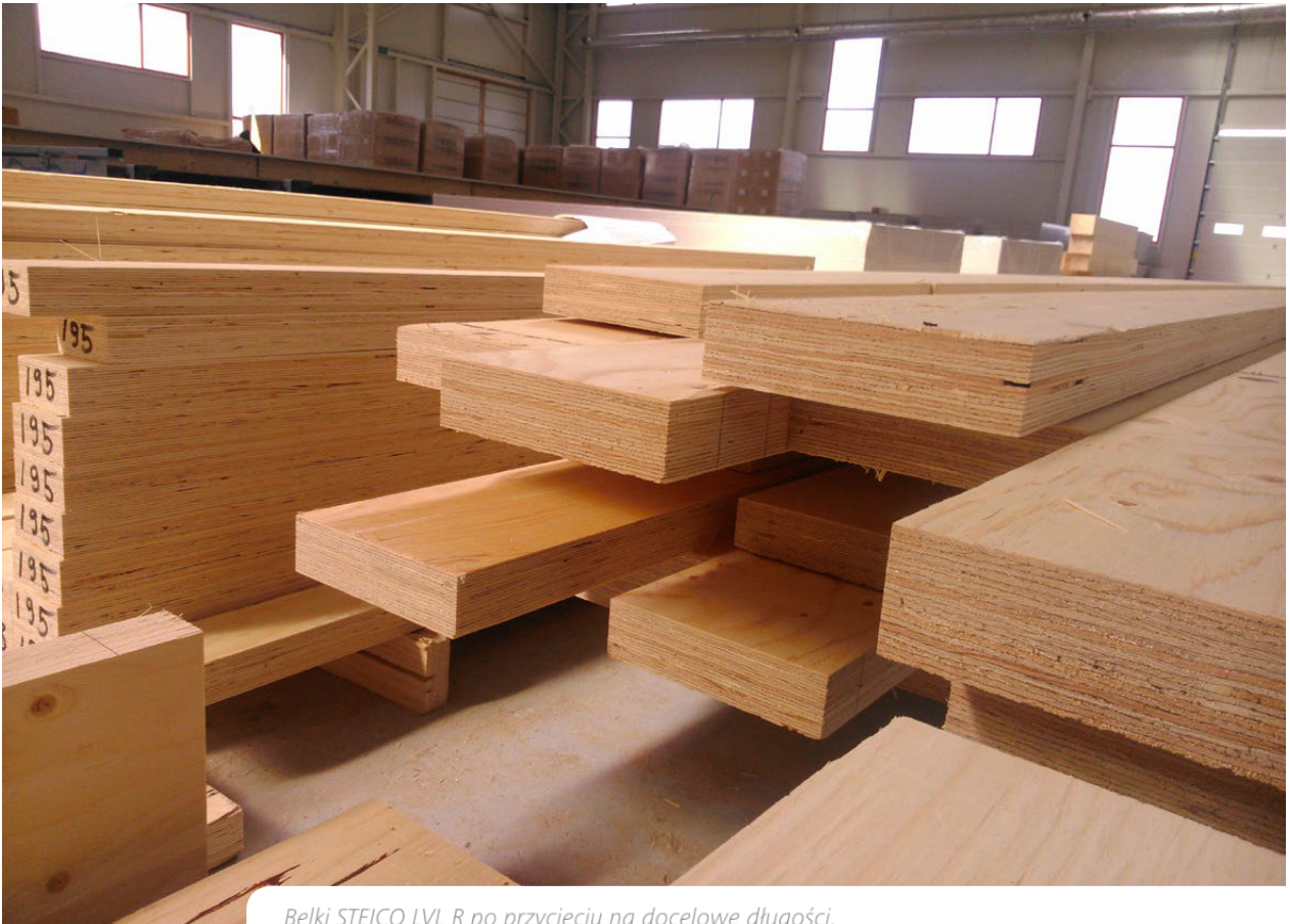
Belki STEICO LVL R po przycięciu na docelowe długości.
